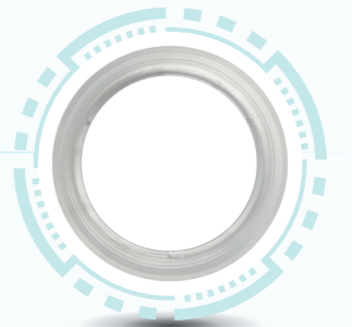
材料：石英玻璃 加工特征：车铣、绕铣、螺旋加工 加工要求：无崩边，无明显刀纹 表面粗糙度要求：Ra < 0.4μm
