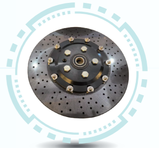
材料：碳/陶复合材料 加工特征：加工内圆轮廓、铣台阶、钻孔 尺寸：D380x20.5mm
