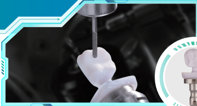
修复冠 加工材料:玻璃陶瓷 加工特征:铣削 工件硬度:HVT60
