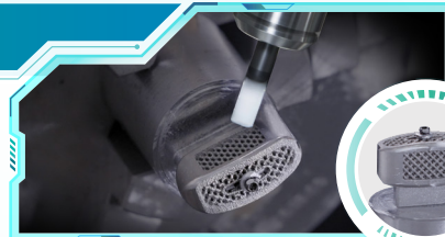
腰椎融合器 加工材料:3D打印钛合金TC4 加工特征:铣削外轮廓 工件尺寸:25x12x10mm
