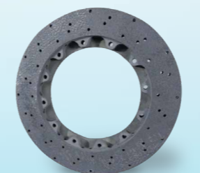
材料: 碳/陶复合材料 加工尺寸: D380x20.5mm 加工特征: 加工内圆轮廓、铣台阶、钻孔
